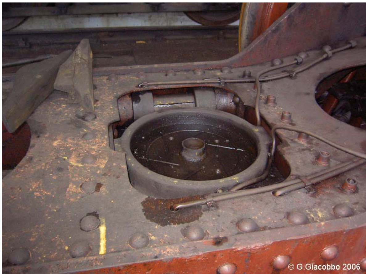
Foto 2 Ralla di appoggio e rotazione
